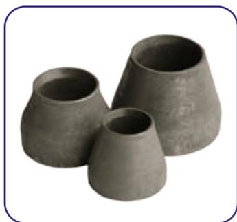
**ПЕРЕХОД** – деталь, предназначенная для плавного изменения диаметра трубопровода. Элемент стального трубопровода, конусообразный, бесшовный (т.е. на нем нет сварочных швов, его поверхность как снаружи, так и внутри имеет ровную, гладкую поверхность), приварной (т.е. отводы соединяются с трубопроводом методом сварки (привариваются)).
