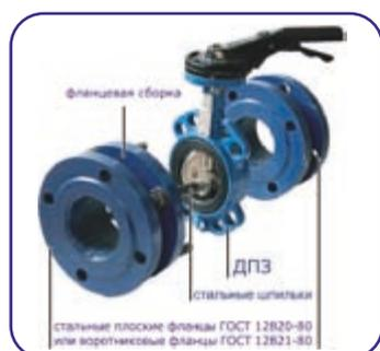
Затворы дисковые поворотные SK-Arm трехсоставные (ЗДПТ) с ручным (от рукоятки), ручным редукторным или электроприводным управлением и фланцевым или под приварку подсоединением к трубопроводу при условном проходе Ду до 500 мм и условном давлении Ру до 1,6 МПа (16 кгс/см<sup>2</sup>).
