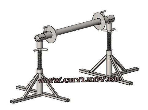
Стойка кабельная (кабельный домкрат) ДВ 2 – предназначена для смотки кабельнопроводниковой продукции с барабанов с 10-го до 16-го типоразмера, массой до 2000 кг. В комплект входит: 2 стойки, ось диаметром 48мм с поджимными башмаками. Диаметр поднимаемых барабанов 1000...1600мм.
