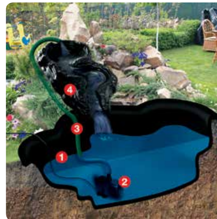
Схема устройства ручейка с замкнутой системой водоснабжения
